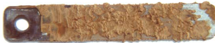
Cupón después de estar expuesto a un ambiente corrosivo
